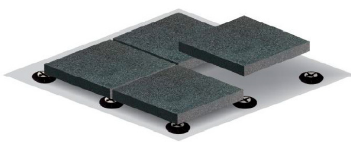
SOBRE PISO TÉCNICO
